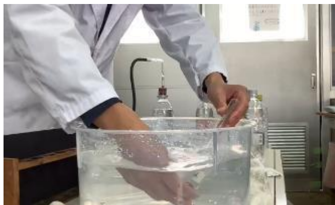
炭酸水から出る二酸化炭素を試験管に集める実験
