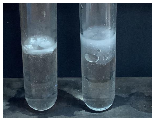
左：うすい塩酸とアルミニウム（アルミ） 右：うすい塩酸とスチールウール（鉄）
