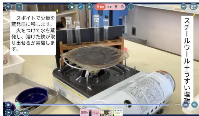
↑うすい塩酸に溶けたスチールウールを取り出す蒸発実験
