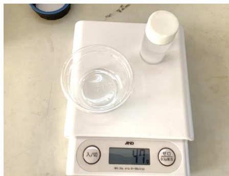
溶ける前と溶かした後では、重さが同じ。空の容器も全部測ります。
