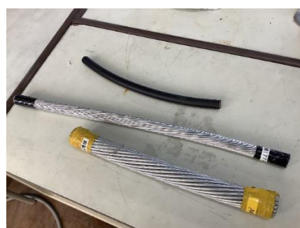
配電線（手前：アルミ製 黒：銅製）
