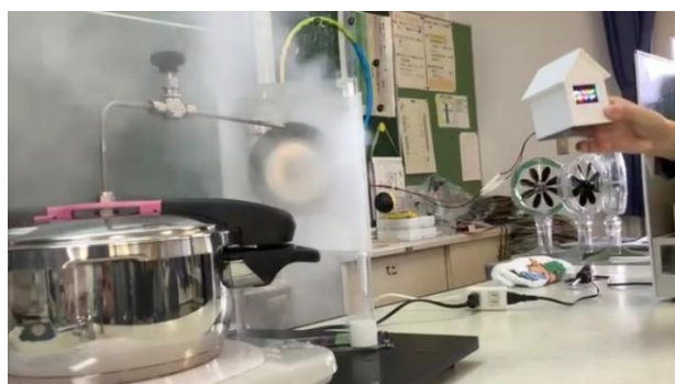
蒸気をためて一気に噴き出し、タービンを回す装置
