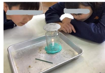
線香の煙で空気の流れを確かめる。
